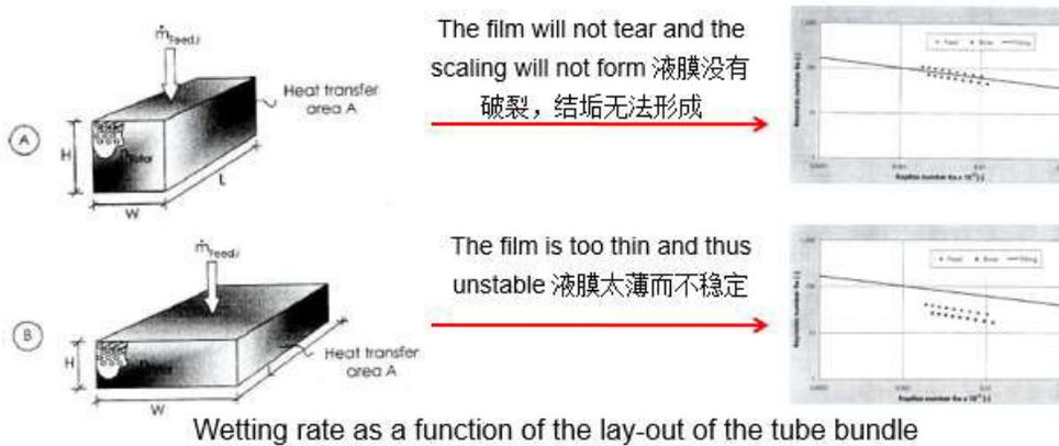
El hecho de que los evaporadores de una planta de desalinización de agua de mar de efecto múltiple puedan diseñarse usando estas pautas se comprueba mediante el resultado de un control para una planta de 9 efectos en funcionamiento.
