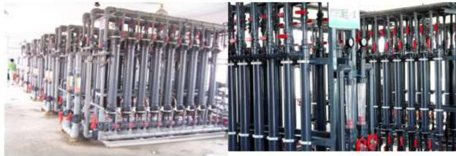
百吨级气态膜提溴中试装置 (PVDF 膜)
