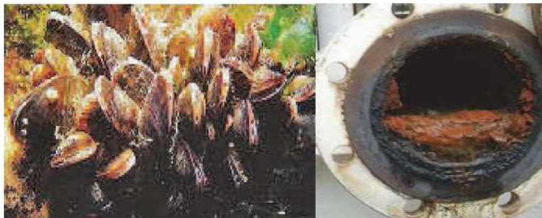
El cloro se agrega en la toma. La posición de dosificación del cloro generalmente se encuentra en el punto de entrada de agua.
